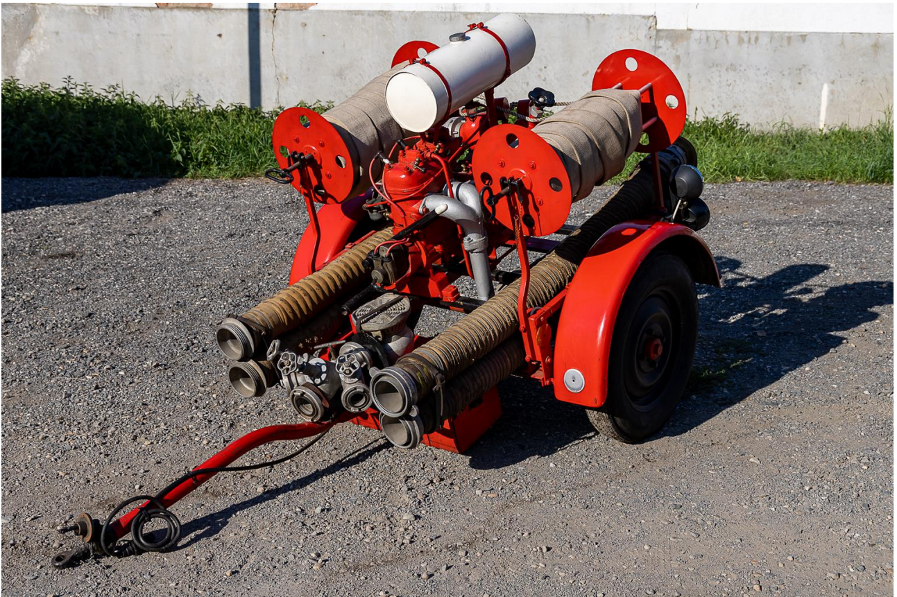
Požární přívěs s přenosnou motorovou stříkačkou 6, Josef Vystrčil a syn, Telč 1948 Motor a čerpadlo na nosítkách z trubek ke snadnému přenášení k vodnímu zdroji
