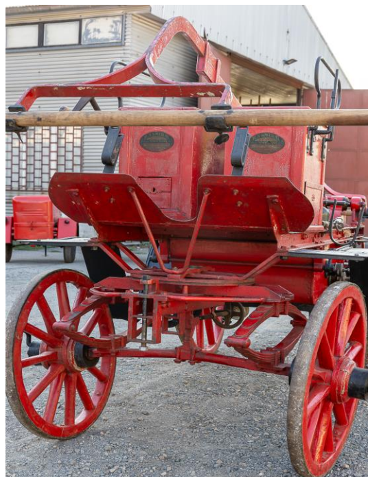
Kombinovaná stříkačka čtyřkolová pro koňskou přípřež, R. A. Smekal Praha Smíchov, 1892 zmotorizovaná 1923
