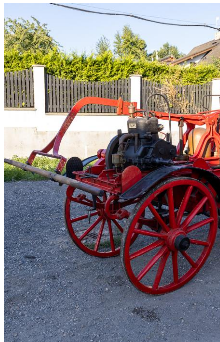
Kombinovaná stříkačka čtyřkolová pro koňskou přípřež, R. A. Smekal Praha Smíchov, 1892 zmotorizovaná 1923
